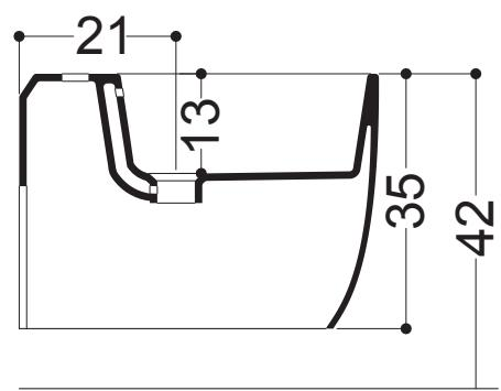
N.B.: Le misure indicate possono subire una variazione dello 0,8 % circa, dovuta ad usura stampi o a piccole variazioni delle caratteristiche tecniche relative alle materie prime che compongono l' impasto.
